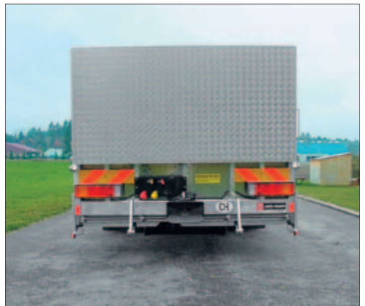
Auffahrrampe mit Aluminium-Warzenblech belegt
