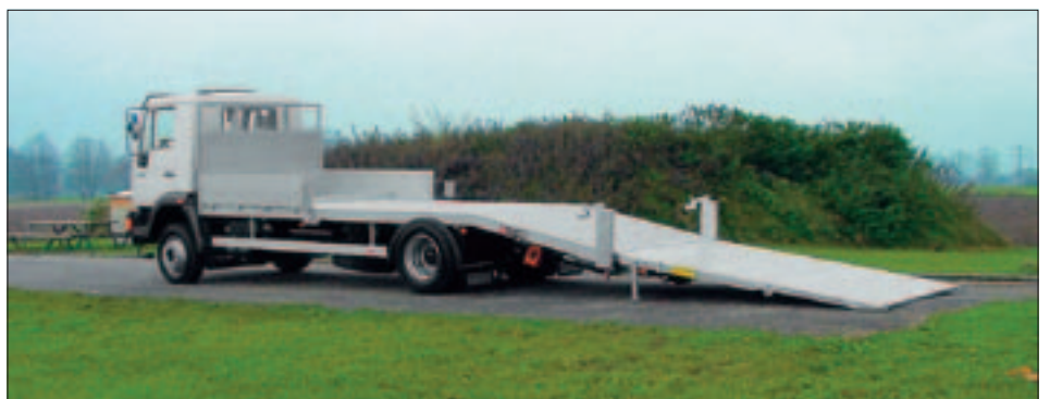
Kröpfung am Heck inkl. den notwendigen Chassisarbeiten und Chassisverstärkungen
