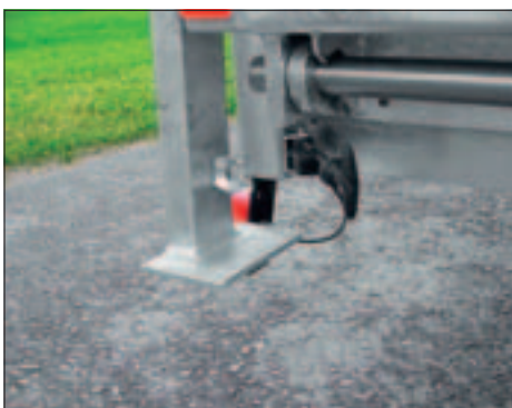
Stützen zur Stabilisierung
