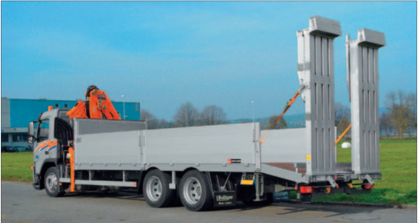
Auffahrrampe 2-teilig aus Aluminium, Tragkraft 14 t, hydraulisch abklappbar, 2. Teil manuell ausklappbar
