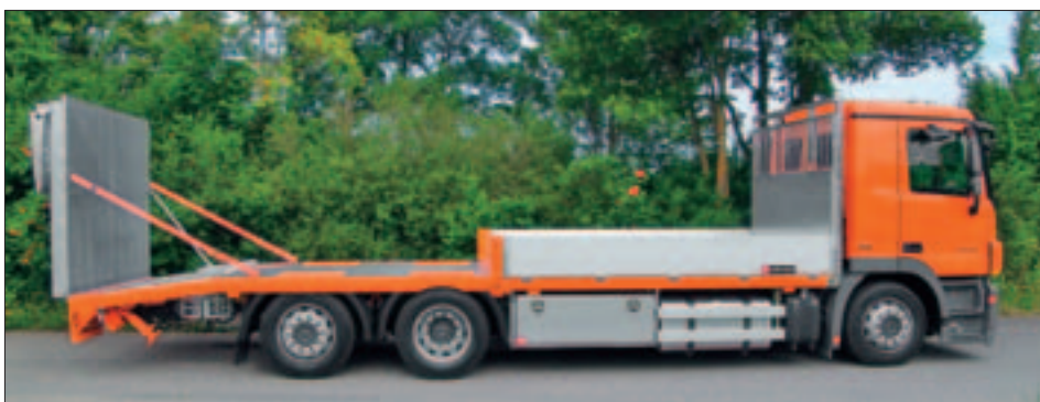
geringe Einladehöhe von 1040 mm für eine maximale Nutzhöhe Auffahrrampe 2-teilig aus Stahl, Tragkraft 8 t, hydraulisch abklappbar
