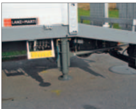
Stützen hydraulisch zur Stabilisierung
