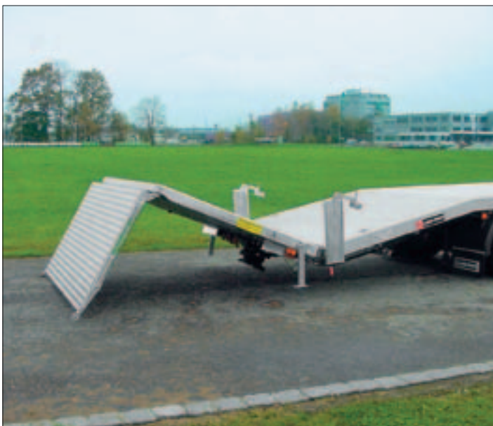
autonomer Scheren-Mechanismus mit Rollen an der 2. Rampen-Plattform
