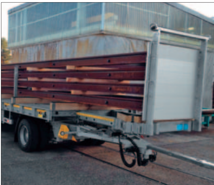
Langmaterial-Auszug nach vorne mit Stirnwand und elektro-pneumatisch verstellbarem Deichsel
