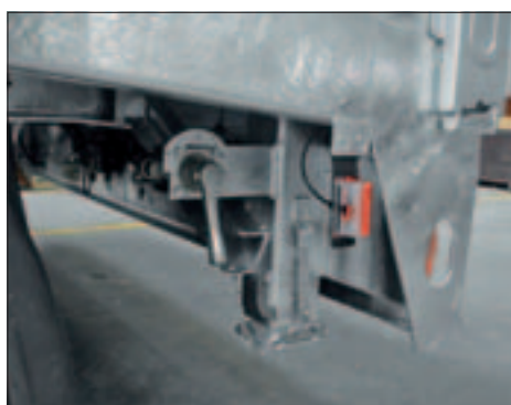
Fallstützen zur Stabilisierung
