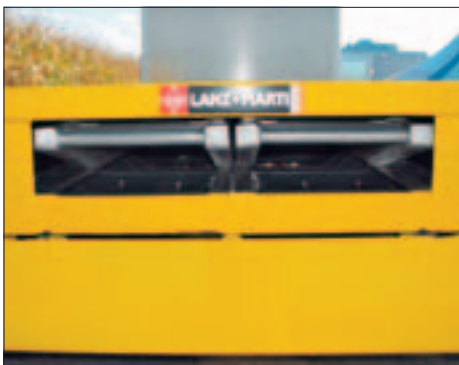
Depot für Auffharrampen, hinten zwischen den Chassisträgern
