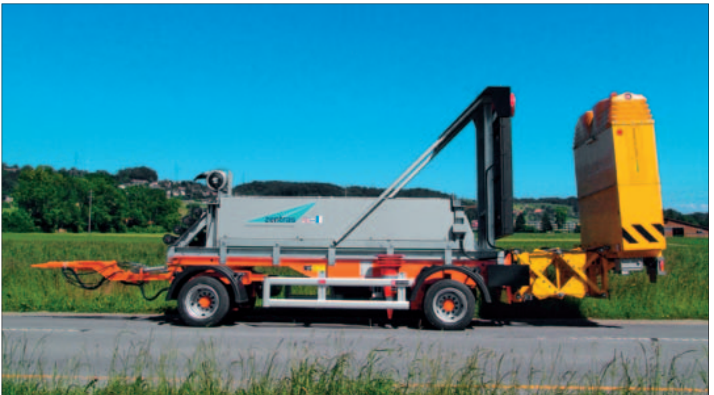
für öffentliche Betriebe mit Ramppuffer, Verkehrsleit-System und Ballast-Gewicht
