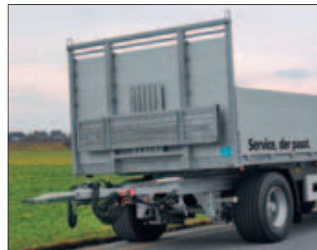
Depot für Rungen an der Stirnwand
