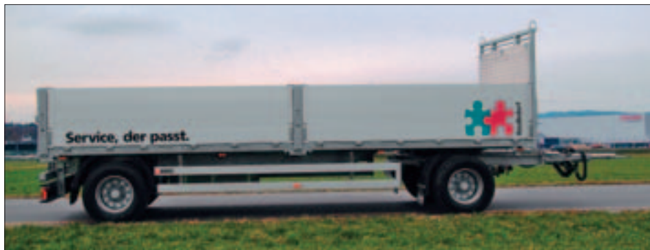
Chassis-Plattform feuerverzinkt für hohe Lebensdauer
