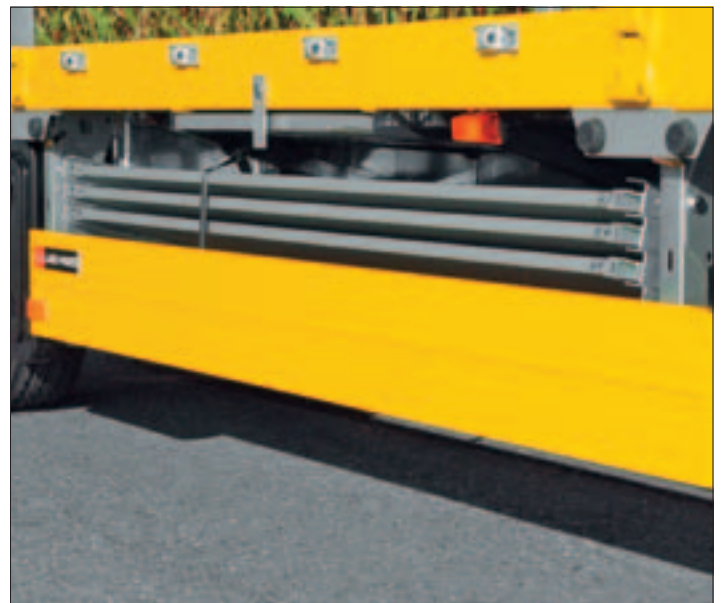
Depot für Seitenladen seitlich zwischen den Achsen
