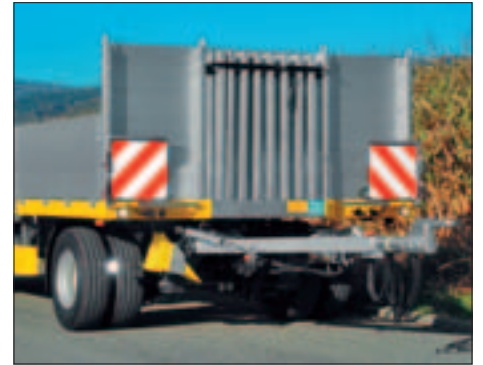
Depot für Rungen an der Stirnwand
