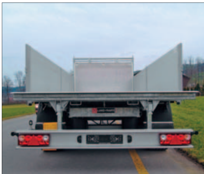
Heck-Unterfahrerschutz mit Beleuchtung, ausziehbar
