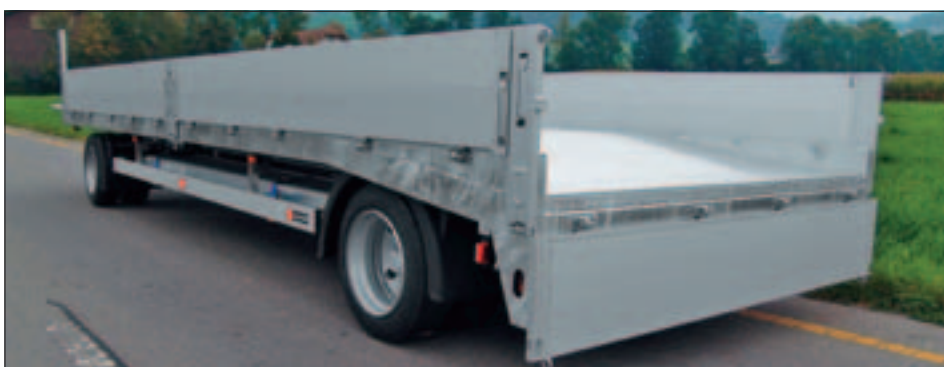
Kröpfung am Heck für einen kleinen Auffahrwinkel
