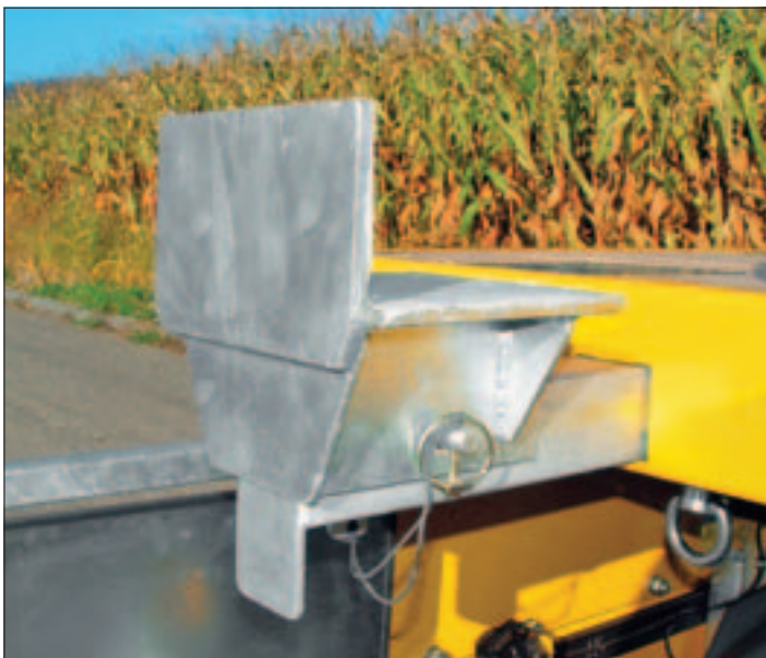
Verbreiterungen ausziehbar für Containertransporte über 2550 mm
