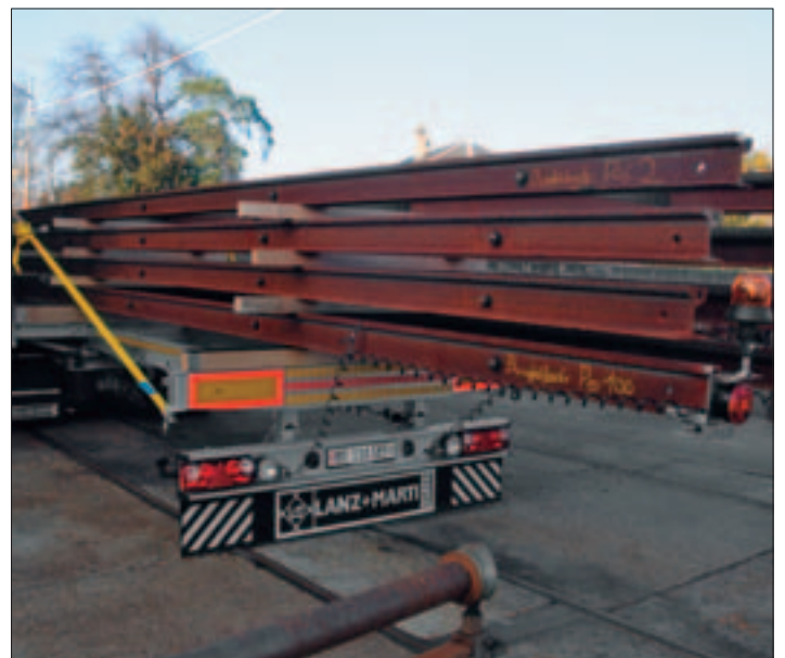
Langmaterial-Auszug mit Heck-Unterfahrerschutz und Beleuchtung
