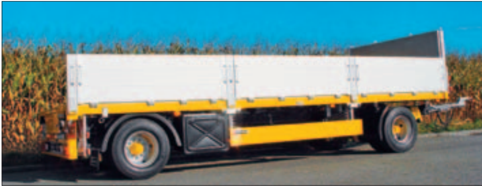
geringe Einladehöhe für eine Nutzhöhe von 3000 mm
