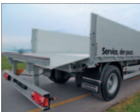
Langmaterial-Auflage komplett ausgestossen und hochgeklappt
