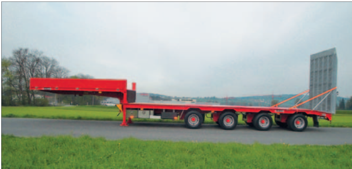
4-Achs-Sattelaufliieger / zulässiges Gesamtgewicht 52 t 2. – 4. Achse stangengelenkt, 4 Stk. 11 t Achsen Fabrikat BPW
