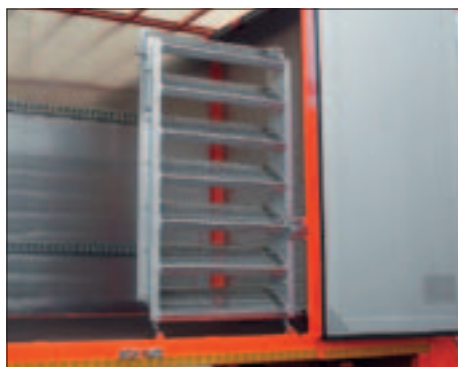
Auffahrrampe 3-teilig, Tragkraft 12 t mit Federhebe-Unterstützung
