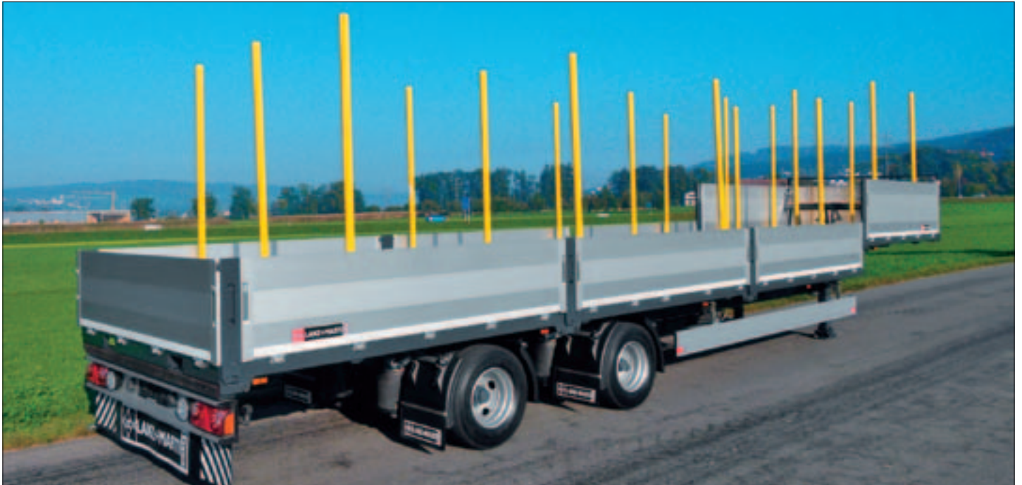
2-Achs-Sattelaufliieger gekröpft / zulässiges Gesamtgewicht bis 35 t beide Achsen Achsschenkel-gelenkt, mit hydraulischer Nachlenkung, 2 Stk. 10 t Achsen Fabrikat BPW
