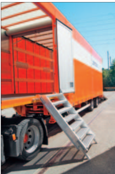
Treppe aus Aluminium 7-stufig, Trittstufen perforiert
