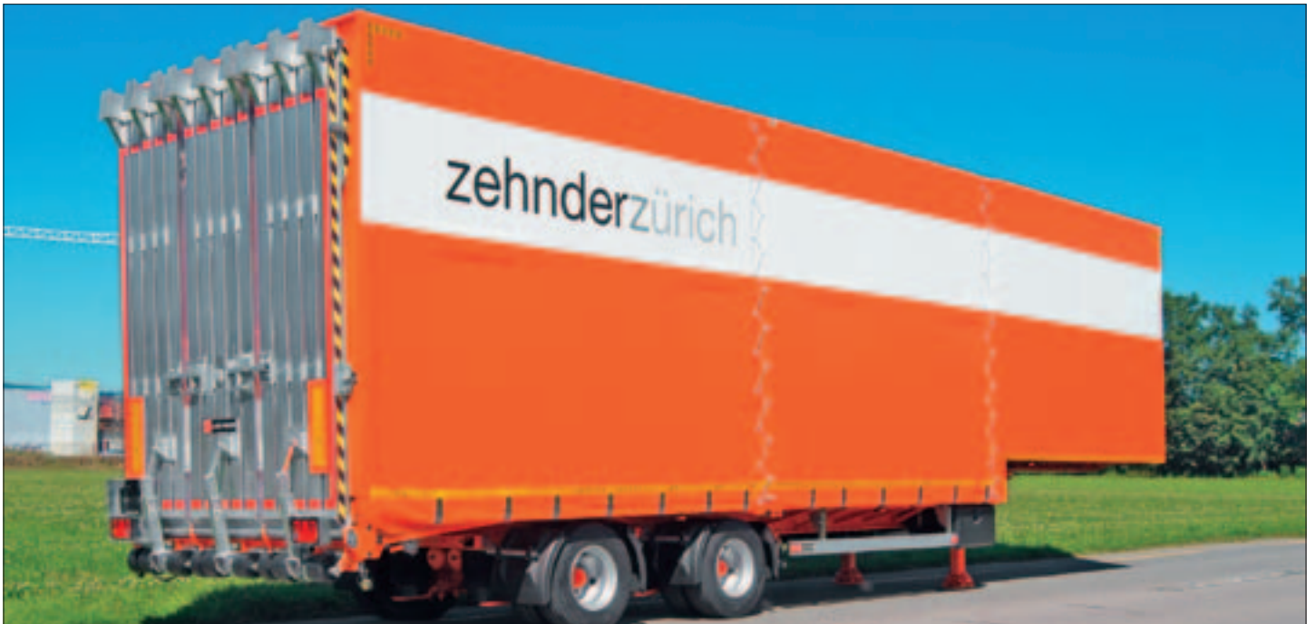
2-Achs-Sattelaufliieger gekröpft mit Blachen-Aufbau / zulässiges Gesamtgewicht 29 t beide Achsen stangengelenkt, 2 Stk. 9 t Achsen Fabrikat BPW
