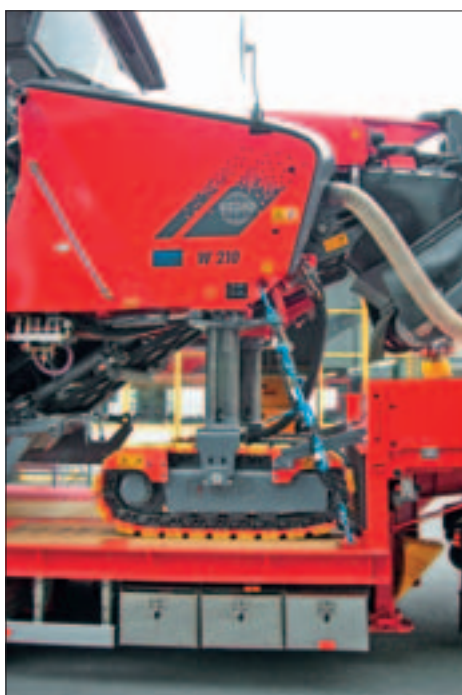
Ladungssicherung Zurropunkte 10 t geprüft
