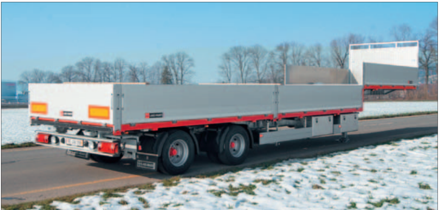
2-Achs-Sattelaufliieger gekröpft / zulässiges Gesamtgewicht bis 35 t beide Achsen stangengelenkt, 2 Stk. 10 t Achsen Fabrikat BPW
