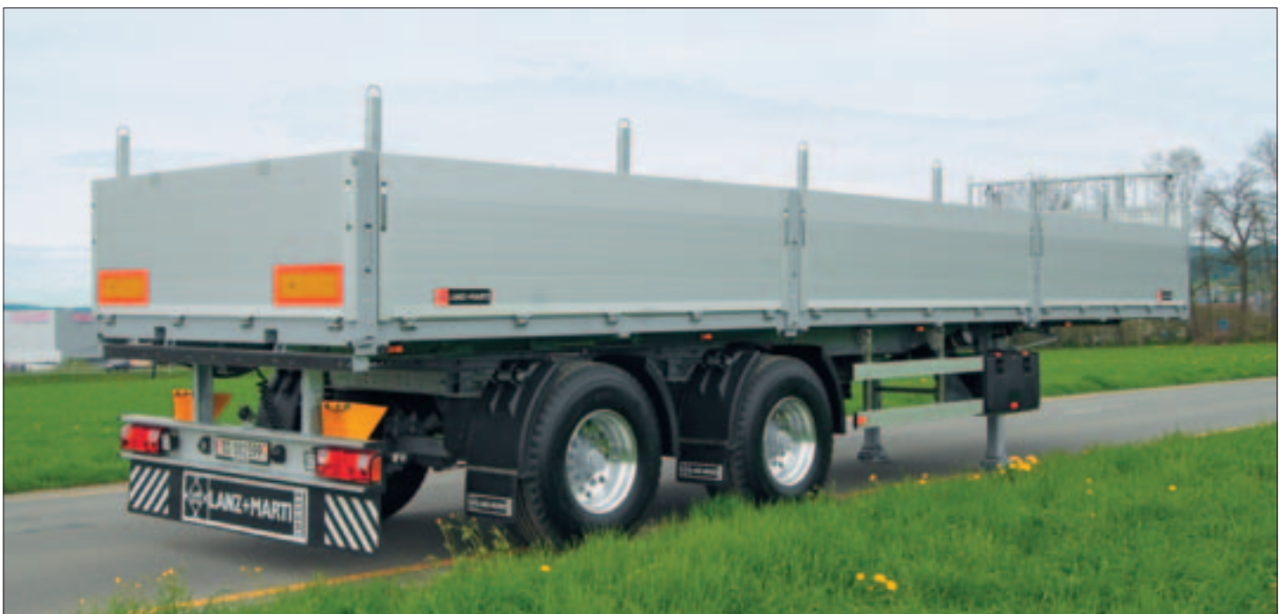
2-Achs-Sattelaufliieger / zulässiges Gesamtgewicht bis 35 t beide Achsen stangengelenkt, 2 Stk. 10 t Achsen Fabrikat BPW
