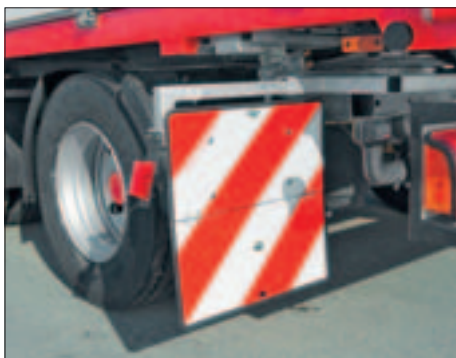
Überbreiten-Markierung ausziehbar, mit Positions-Leuchten
