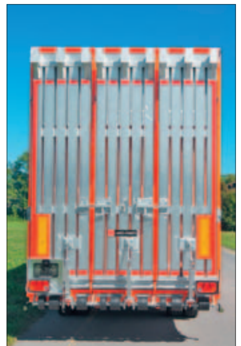
Auffahrrampe 3-teilig, Tragkraft 12 t mit Federhebe-Unterstützung
