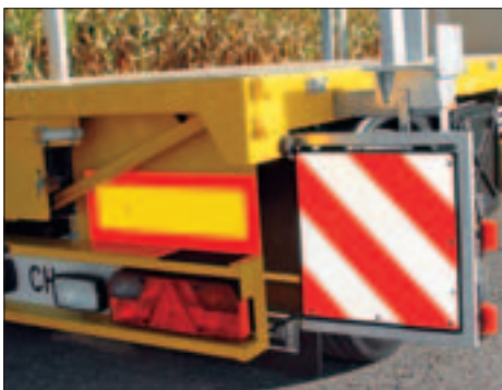
Überbreiten-Markierung ausziehbar, mit Positions-Leuchten
