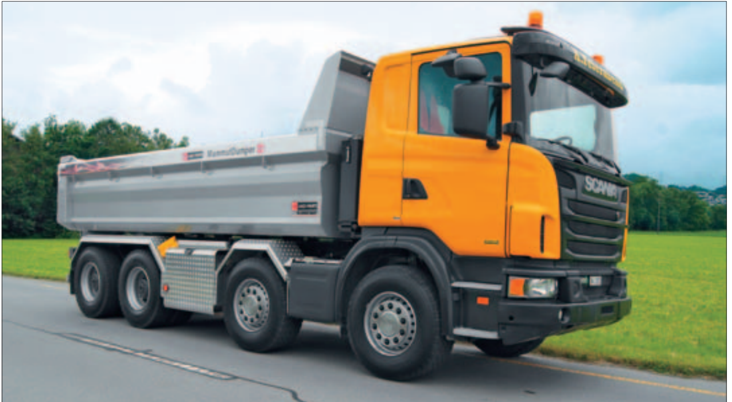
auf einem 4-Achs-LKW mit Teleskopzylinder in der Mitte und in Verbindung mit einem Schnellwechselsystem
