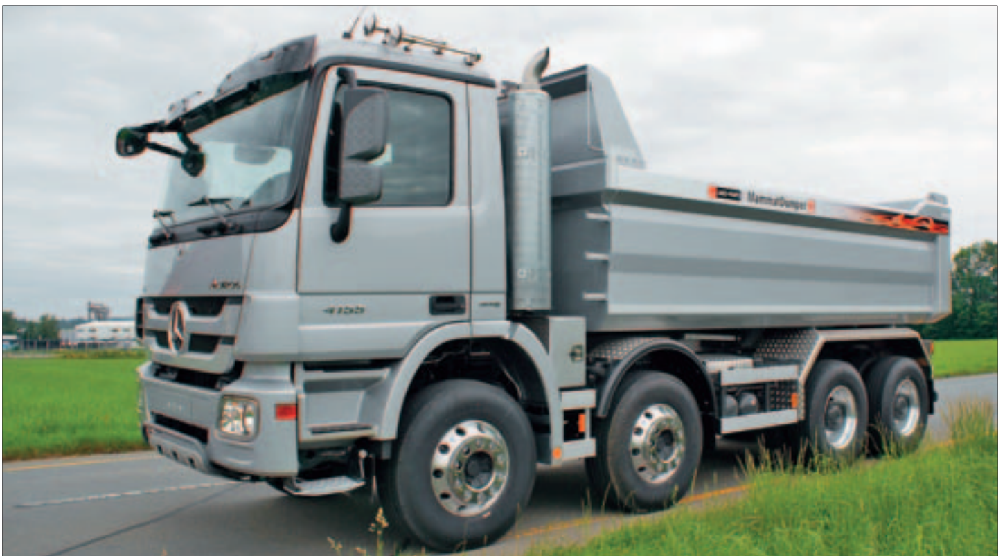
auf einem 4-Achs-LKW mit Front-Teleskopzylinder für höchste Kippstabilität
