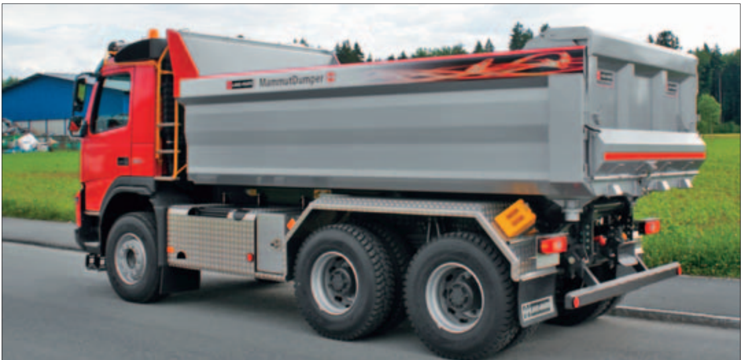
auf einem 3-Achs-LKW mit Teleskopzylinder in der Mitte
